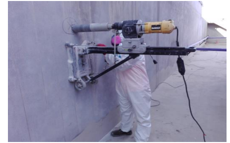
Diamantina de Concreto Análisis de Resistencia al concreto.
